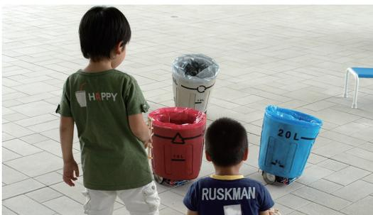
岡田美智男先生のゴミ箱ロボット。ゴミを拾う手がないためモゾモゾしていると、子どもたちが助けてくれて、ゴミ拾いが完了する。写真提供: 岡田美智男
