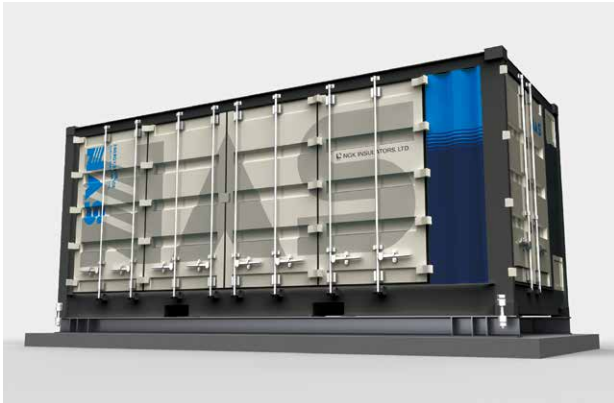
独自の高度なセラミック技術により、メガワット級の電力貯蔵を世界で初めて実用化したNAS電池。大容量、高エネルギー密度、長寿命が特徴で、写真のコンテナ型は20フィート(約6m)コンテナに、電池本体と制御装置を収納。一体輸送をすることで工期を短く、工事費を節減できる
