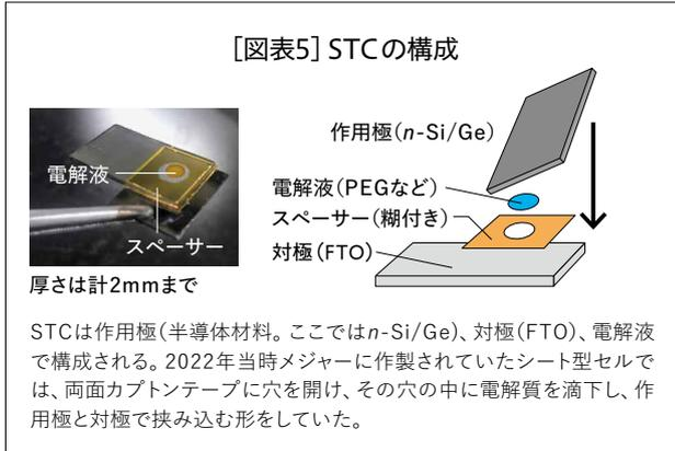
の3つで構成される。2022年当時メジャーに作製されていたシート型セルでは、両面カプトンテープに穴を開けて、そのカプトンテープを対極であるフッ素ドープ酸化スズ(FTO)透明電極に張り付け、テープの穴の中に電解液を滴下し、上から作用極で覆っていた。長期安定測定のためには、このカプトンテープを劣化しない材料に替えることが必要であった。
