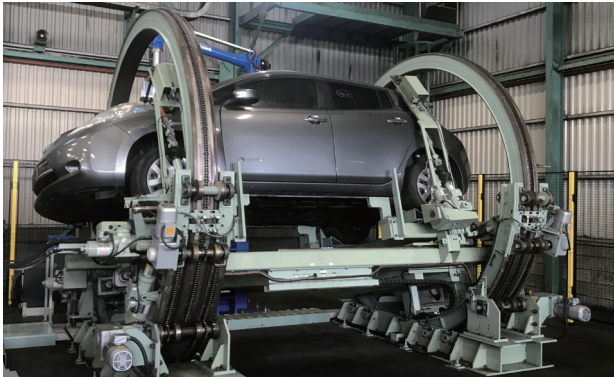
上: 電動車に搭載された使用済みリチウムイオン電池を取り出すために、傾転装置で車を反転させる。下: 電池ユニットからレアメタルを回収するための解体ライン
