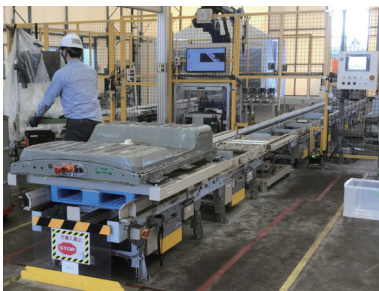
上: 電動車に搭載された使用済みリチウムイオン電池を取り出すために、傾転装置で車を反転させる。下: 電池ユニットからレアメタルを回収するための解体ライン
