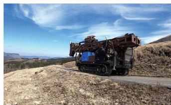
町おこしエネルギーが開発したオリジナルの掘削機。上：掘削の際には搭載したアームを櫓の代わりに使用するため、基礎工事や機材搬入が不要。下：コンパクトな自走式のため、大型車両では入りづらい場所でも調査掘削が可能に
