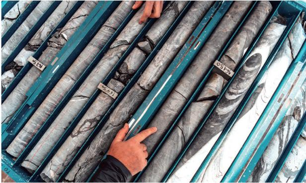
坑井調査で掘り出した筒状の地層のコア。地熱発電の熱源を探るだけでなく、将来の鉱物資源開発を見据えた貴重なサンプルにもなる
