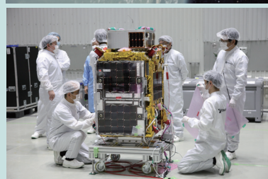
磁石で宇宙ごみを捕獲するデブリ除去技術実証衛星「ELSA-d」(上)。2021年2月にカザフスタンでのELSA-dの打ち上げ前テストの様子(下)
