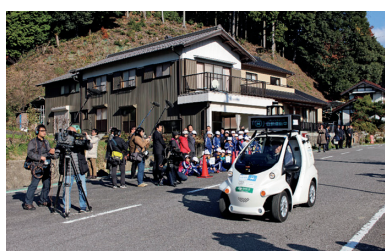
小型電気自動車 (EV) 「コムス」の公開実証実験では、時速15kmで約600mの市道を2往復した
