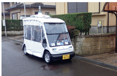
小型電気自動車 (EV) 「コムス」の公開実証実験では、時速15kmで約600mの市道を2往復した
