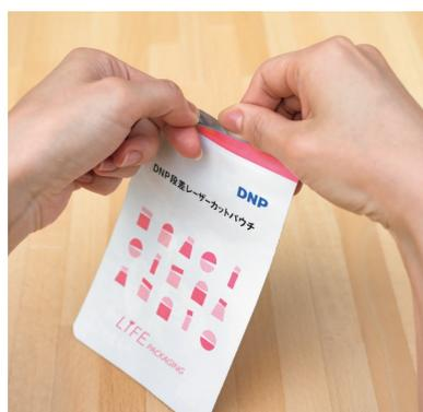
「DNP 断熱レーザーカットパウチ」は、フィルムの表面にレーザーを照射することで開封口に段差が付き、指でつまみやすく、開けやすくしている
