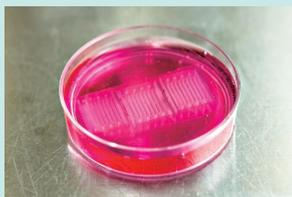
②培養した細胞とコラーゲンを混ぜ合わせたものを鋳型に流し込み、シート状の「筋芽細胞モジュール」をつくる
